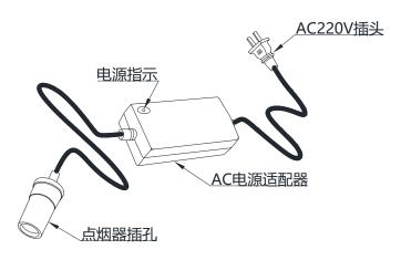
(1) 当使用汽车直流电源(12V)充电时,将 DC 充电器的点烟器插头插入汽车点烟器插孔;需要使用交流电源充电时,将 DC 充电器的点烟器插头
