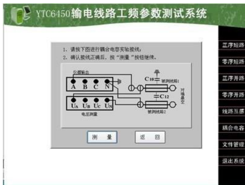
图 6-19 耦合电容测量接线提示
